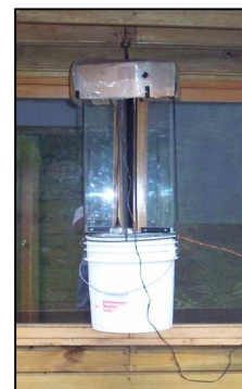
Figura 3: Trampa de luz instalada.
